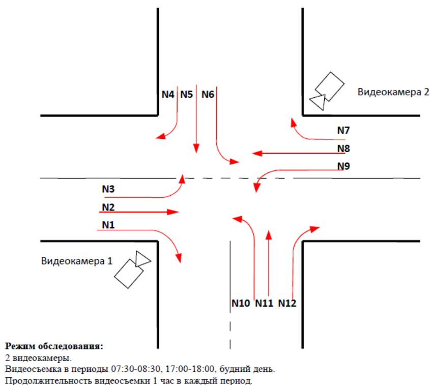
Рисунок 6 - Обследование интенсивности движения четырехстороннего перекрестка
