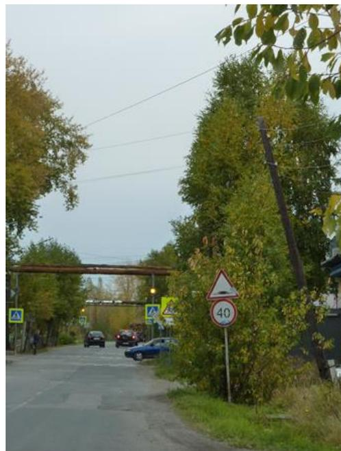
Рисунок 18 – Типичная ситуация, характеризующая условия видимости ТСОДД и участников движения на значительной части местной УДС г. Серова
