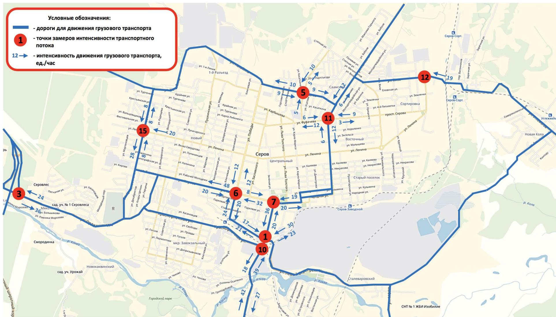
Рисунок 27 – Карт-схема с указанием интенсивности движения грузового транспорта на УДС в г. Серова
