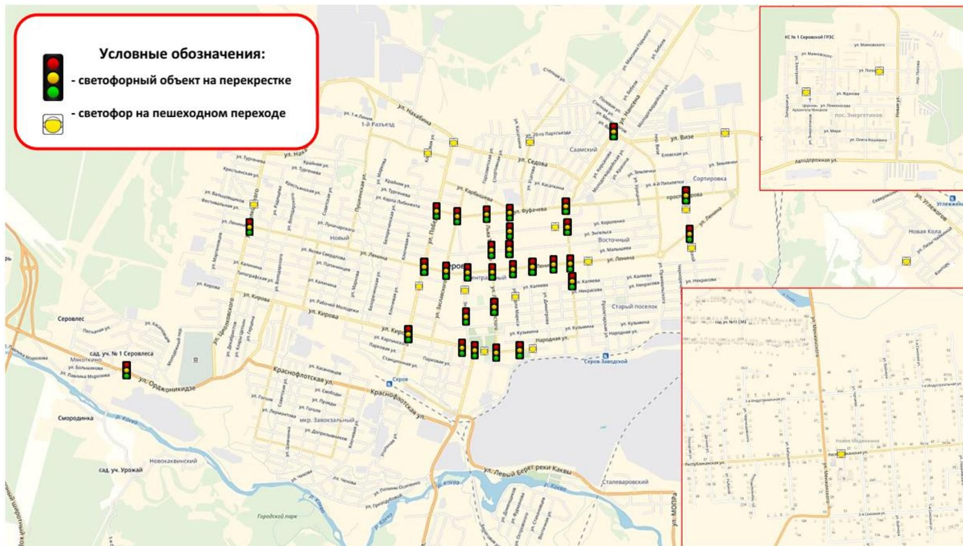
Рисунок 13 – Карт-схема дислокации светофорных объектов на территории г. Серова
