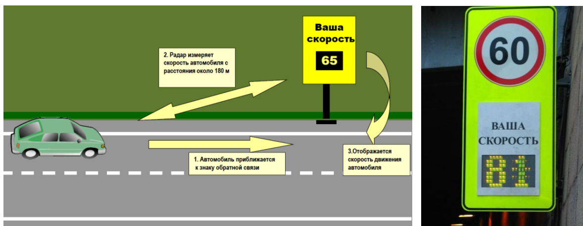
Рисунок 27 – Принцип действия знаков обратной связи с водителями
