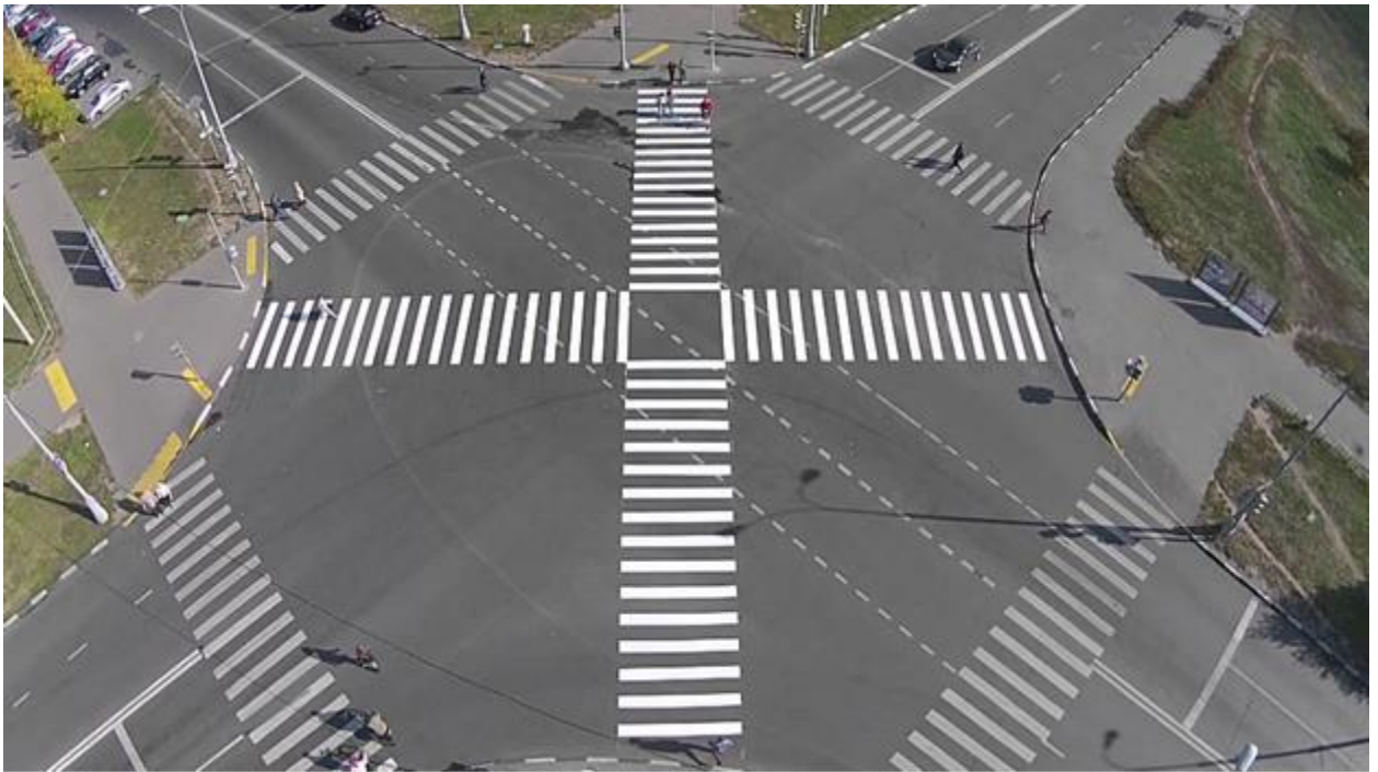
Рисунок 25 – Пример организации диагонального пешеходного перехода с нанесением разметки 1.14.1 или 1.14.2
